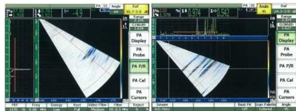
フェイズドアレイ超音波探傷器による損傷部の表示例
